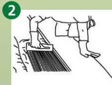
Personal especializado debe instalar el césped mediante orientación adecuada de los rollos y pegado a la superficie base con un adhesivo de contacto adecuado.
