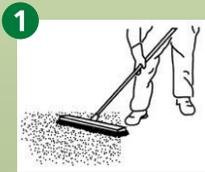
Limpiar la superficie, afinar para eliminar grietas e irregularidades asegurando desnivel para evacuación de lluvias.
